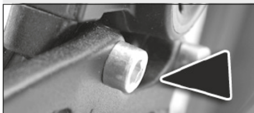
Vis connexion, pas correct Une vis desserrée est souvent indiquée par une tête de vis saillante.
