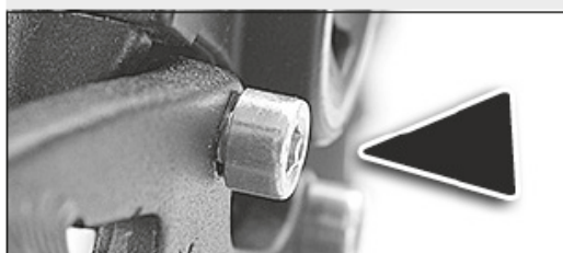
Vis connexion, pas correct Une vis desserrée est souvent indiquée par une tête de vis saillante.
