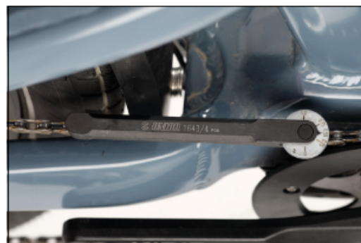
Image: Jauge d'usure de chaîne
