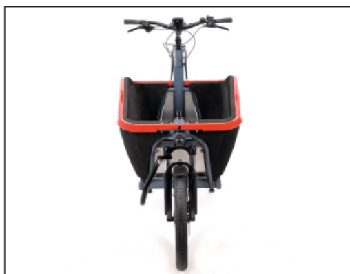
Image: Potence et guidon correctement alignés
