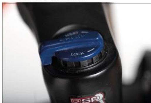
Image: Fourche à suspension verrouillée (=LOCK)
