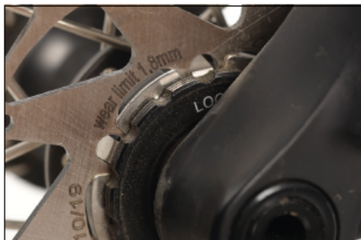
Image: Informations sur l'épaisseur minimale sur le disque de frein (1,8 mm)
