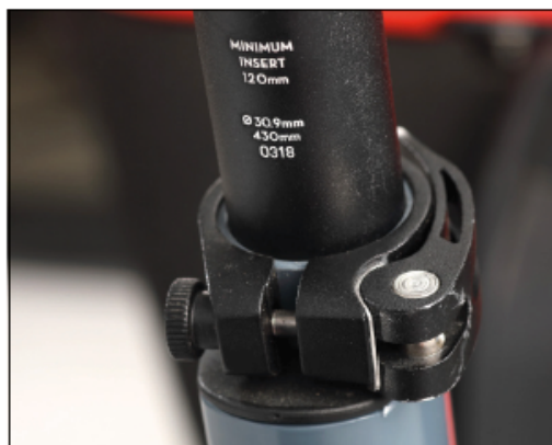
Image: Marquage pour la tige de selle minimale profondeur d'insertion
