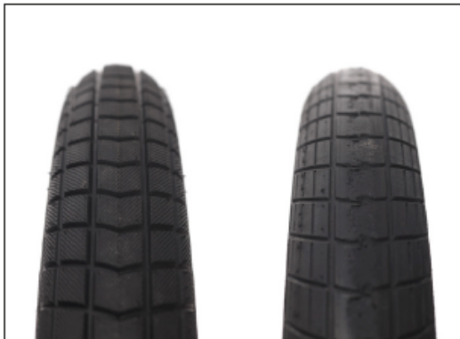
Image: Bande de roulement optimale du pneu (à gauche); Bande de roulement du pneu usée (à droite)
