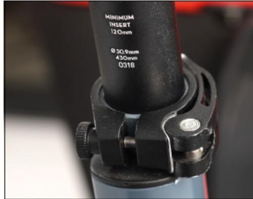
*Image: Marquage pour la tige de selle minimale profondeur d'insertion*
