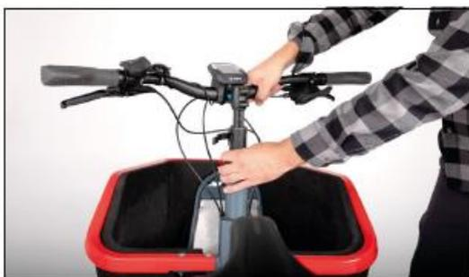
Image: Réglage de la hauteur du guidon
