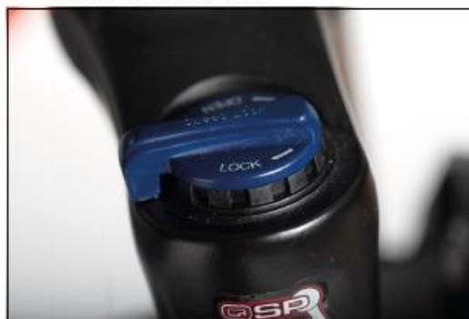
Image: Fourche à suspension verrouillée (=LOCK)
