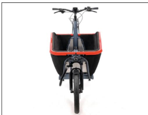
Image: Potence et guidon correctement alignés
